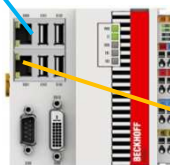
Децентрализованный процессор (напр. этажный контроллер)
